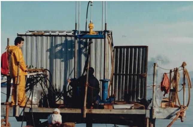
Fig. 21 - Il pressimetro autopercorante Camkometer del Politecnico di Torino (cantiere Panigaglia - Golfo di La Spezia), 1978.
