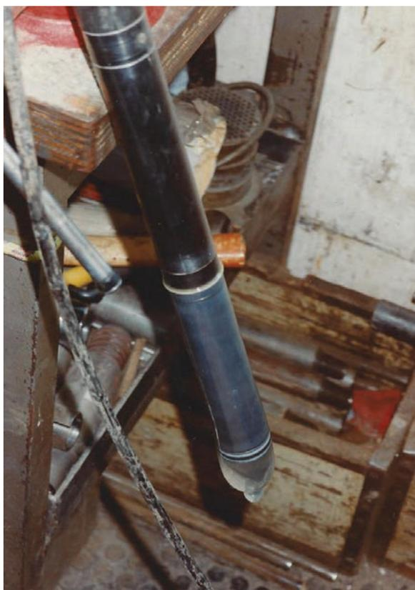
Fig. 25 - Il piezocono, pronto per essere inserito nel preforo (1986).
