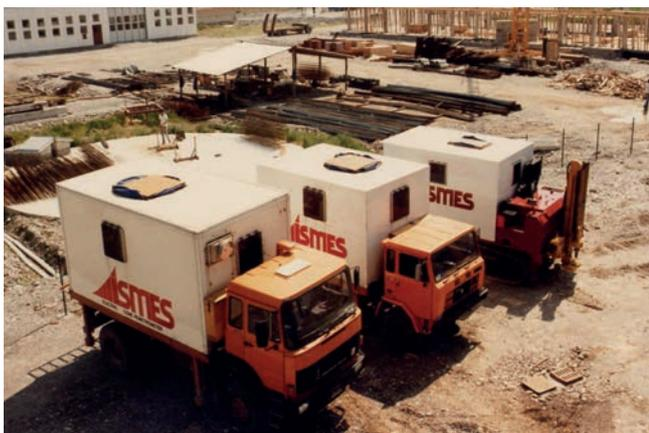
Fig. 24 - I mezzi ISMES per le prove penetrometriche statiche (1981).
