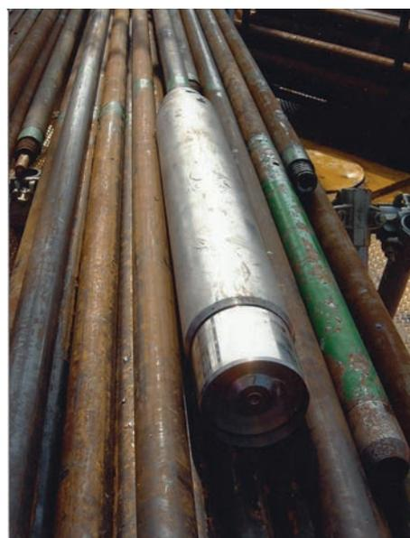
Fig. 8 - Il campionatore a pistone fisso a pareti sottili Osterberg (1961).
