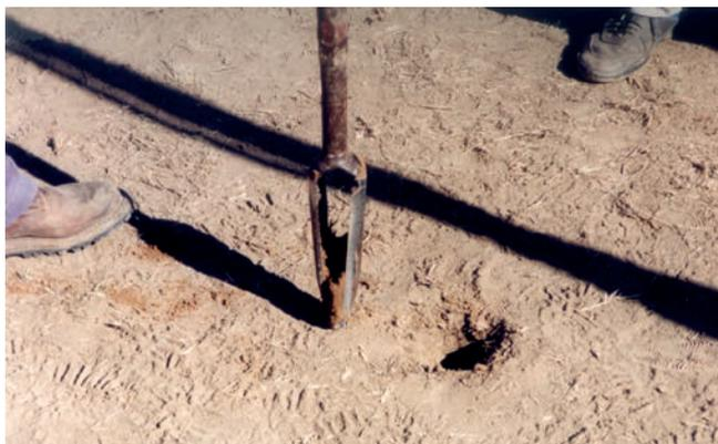
Fig. 5 - Perforazioni con trivella azionata manualmente per eseguire prove pressiometriche Menard (1961).
