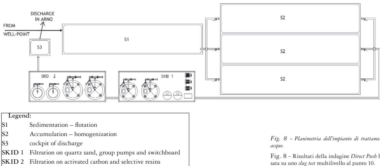
Fig. 8 - Planimetria dell'impianto di trattamento acque.
