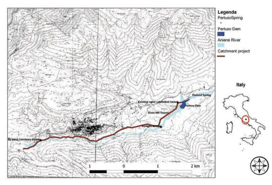
Fig. 4 - Design of the exploitation project of Pertuso spring. Fig. 4 - Progetto di consolidamento della sorgente Pertuso.
