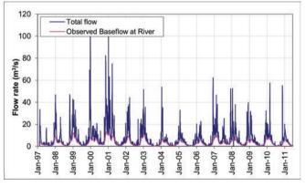
Fig. 3 - Streamflow hydrograph analysis with baseflow separation. Fig. 3 - Analisi dell'idrogramma fluviale con separazione del deflusso di base.
