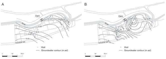
Fig. 2A, B - Groundwater contour maps under static and abstraction conditions. Fig. 2A, B - Piezometrie in condizioni statiche e dinamiche.
