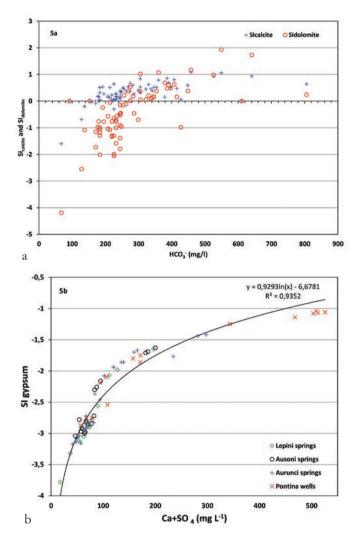
*Fig. 5a, b - Saturation indices (S.I.) with respect to calcite, dolomite and gypsum.* Fig. 5a, b - Indice di saturazione (S.I.) rispetto a calcite e dolmite (a) e gesso (b).
